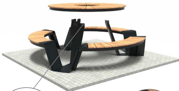
2. La console centrale ou la console du parasol peut alors être placée par le bas et attachée à l'ensemble de pique-nique. Alignez les points de montage sur la console avec les trous de gauche dans les pieds. Utilisez les longs boulons (fournis avec la console) pour relier les pieds, le dessus de table et la console ensemble.
