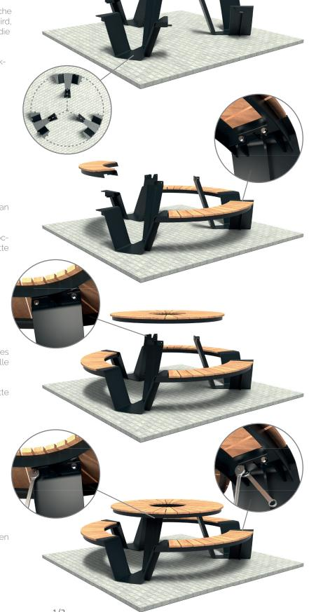
5. Wenn alle Teile richtig positioniert sind, können die Schrauben angezogen werden.
