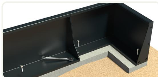
4. Remplissez ensuite l'intérieur du mur de soutènement et pour finir le projet.
