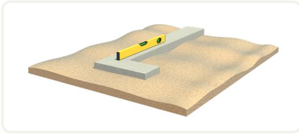
2. Placez les murs de soutènement sur la surface portante. Boulonnez les éléments avec les matériaux fournis.
