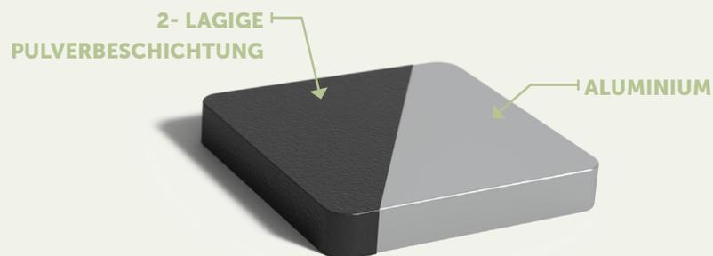
Nach der Herstellung des Aluminium-Briefkastens wird dieser einer Reihe von Nachbehandlungen unterzogen. Das Material wird aufgeraut, damit die Pulverbeschichtung besser haftet. Die Pulverbeschichtung ist in verschiedenen Farben erhältlich und wird mit einer stark haftenden Grundierung aufgetragen. Zum Schluss wird der Briefkasten mit einer harten Deckschicht versehen. Dadurch ist der Briefkasten kratzfest.
